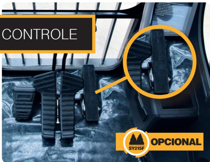
Customizamos novo pedal para facilitar o deslocamento frontal da máquina. Agora, basta o operador pressionar o pedal para ativar simultaneamente as duas esteiras e deslocar a máquina em linha reta.
