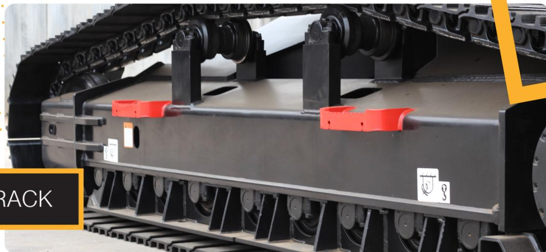
Original de fábrica, protege e previne a entrada de materiais indesejados nos roletes inferiores e na estrutura que envolve todo o conjunto do chassi. Além disso, é dimensionado para absorver torções na corrente da esteira, proporcionando aumento da vida útil do material rodante.
