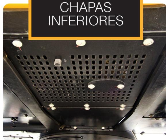
Substituímos as chapas originais por chapas em aço com espessura maior, que oferecem mais resistência aos possíveis impactos durante o trabalho e descolamento do equipamento.
