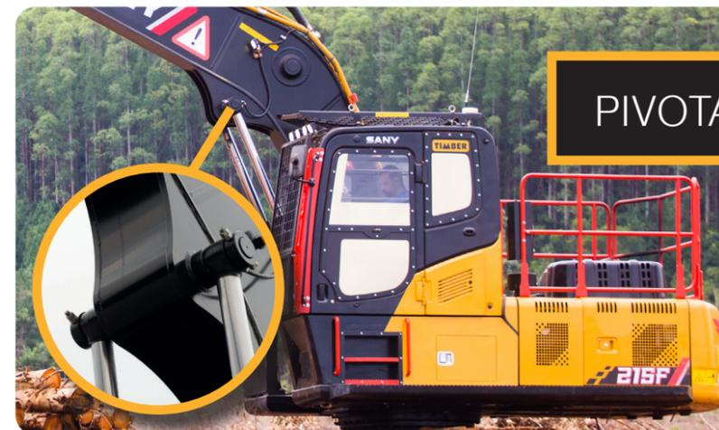
Amplia a altura da lança no carregamento e descarregamento. O recurso facilita a movimentação e diminui o curso dos cilindros da lança. O resultado se traduz em mais agilidade para a máquina e aumento de produtividade ao operador.
