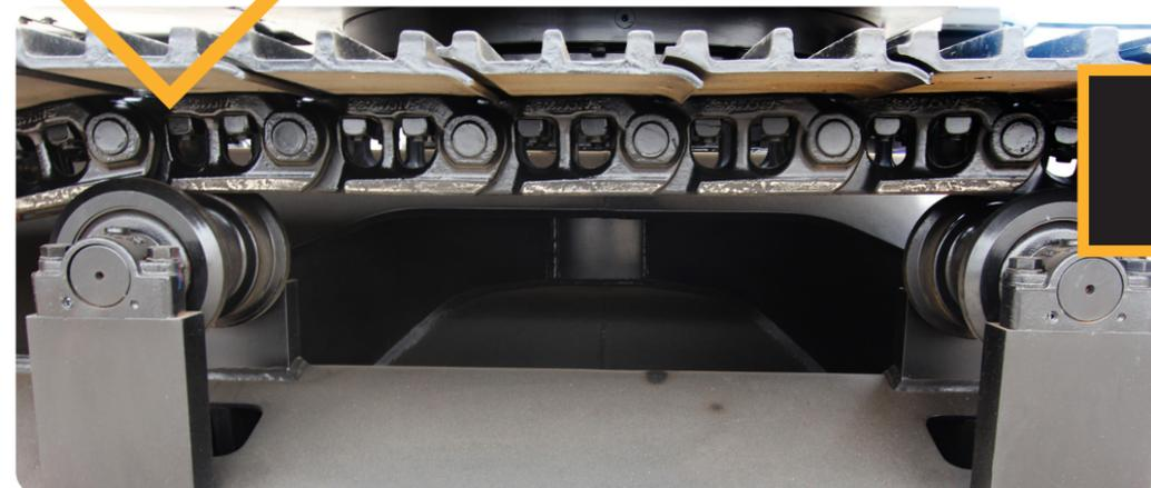
Original de fábrica, os roletes superiores possuem mancal duplo. A configuração amplia a vida útil desta parte, que é padronizada com as mesmas especificações dos roletes inferiores, extremamente robustos.
