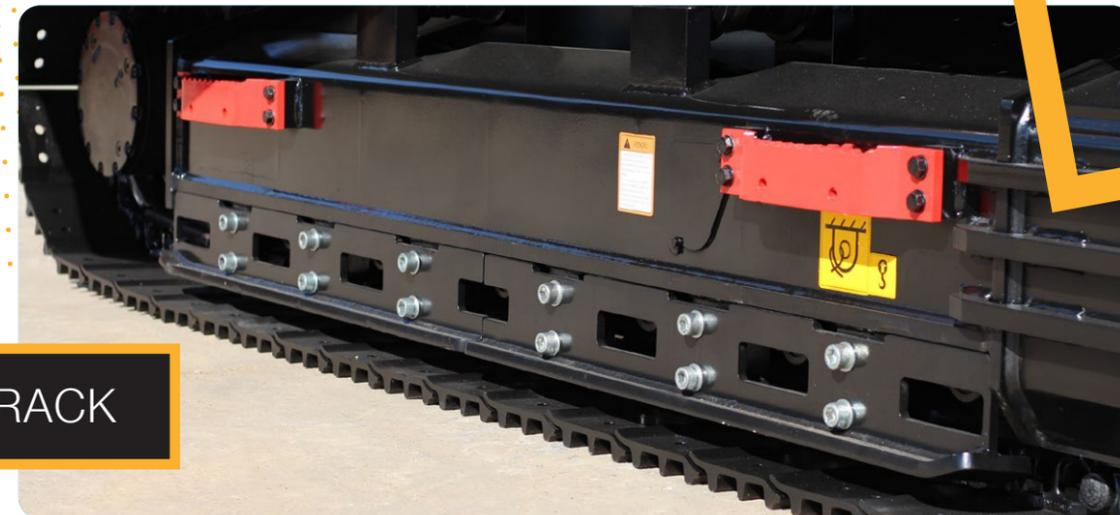
Protege e previne a entrada de materiais indesejados nos roletes inferiores e na estrutura que envolve todo o conjunto do chassi. Além disso, é dimensionado para absorver torções na corrente da esteira, proporcionando aumento da vida útil do material rodante.
