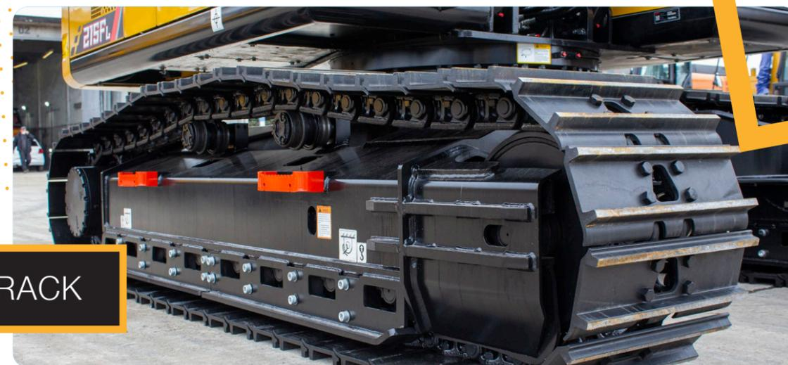
Protege e previne a entrada de materiais indesejados nos roletes inferiores e na estrutura que envolve todo o conjunto do chassi. Além disso, é dimensionado para absorver torções na corrente da esteira, proporcionando aumento da vida útil do material rodante.
