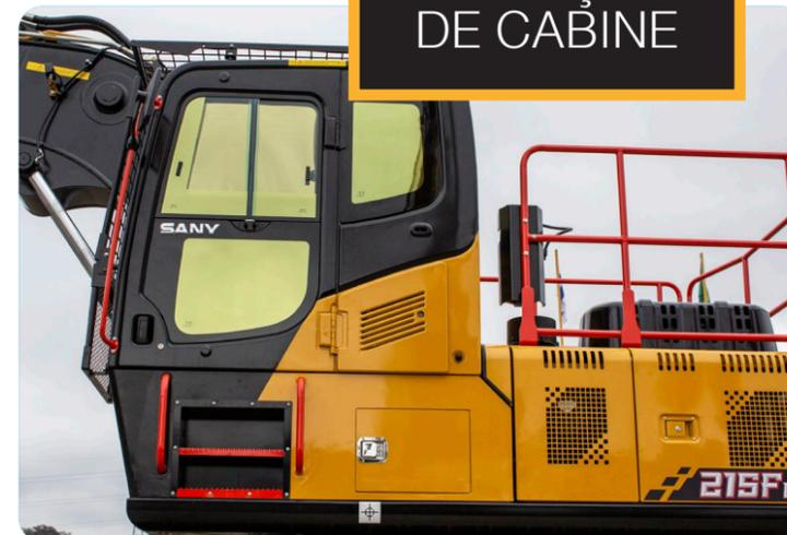
A cabine possui elevação de 600 mm. O recurso permite que o operador tenha visão superior no momento em que executa a operação de carregamento, descarregamento e movimentação das toras. Este item traz mais ergonomia, o que reflete no aumento de produtividade e conforto.
