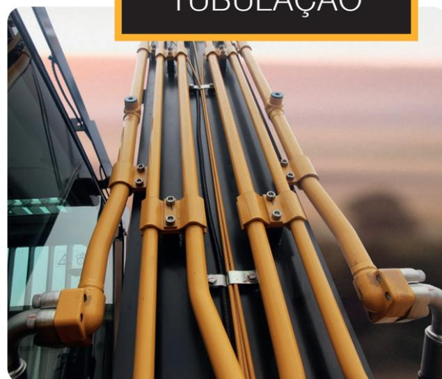
Tubulação hidráulica com diâmetro de 1.¼" original de fábrica. Oferece maior vazão de óleo, evitando restrições. O sistema reduz a temperatura da máquina e previne perdas de potência, possibilitando assim, melhor desempenho e maior vida útil aos componentes hidráulicos.
